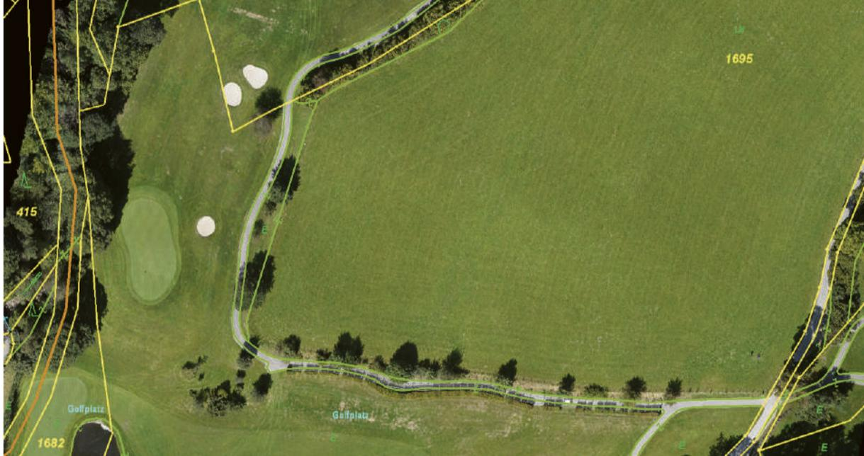
Grenzverläufe lassen sich mit Orthofotos hinterlegen und so mit dem Naturverlauf abgleichen.
